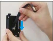
Far passare le viti e il cavo attraverso la base di montaggio.
